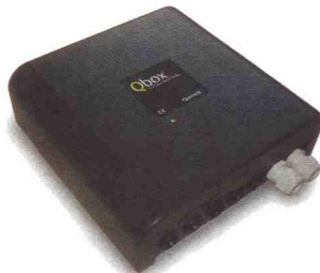
De Qbox bestaat volledig uit bestaande componenten. Hij is speciaal ontwikkeld om sensoren uit te lezen en apparaten te schakelen.
